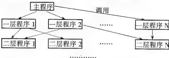
一. 主程序的基本结构是怎样的呢? 见右上角的主控部分流程图:
